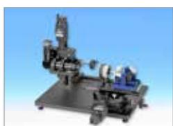
L'éclairage est l'un des principaux problèmes lors de la mesure. Le diffuseur et la lumière d'anneaux d'écart des CT-6000 et 12000 résolvent le problème. La lumière d'anneaux d'écart, éclairant de façon inverse le micro-foret, est montée au besoin sur un support (en option) et un chariot, eux-mêmes placés sur les guides.
