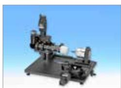
Un support pour mandrin de Röhm (ZG Ø 80 – ID 146 195 – usage jusqu'à 19,5 mm) est installé dans l'emplacement du prisme sur les chariots et fixé avec une vis moletée. Le mandrin est livré sur demande avec son support.
