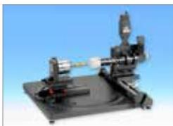
Un support pour mandrin de Röhmm (ZG Ø 80 – ID 146 195 – usage jusqu'à 19,5 mm) est installé dans l'emplacement du prisme sur les chariots et fixé avec une vis moletée. Le mandrin est livré sur demande avec son support.
