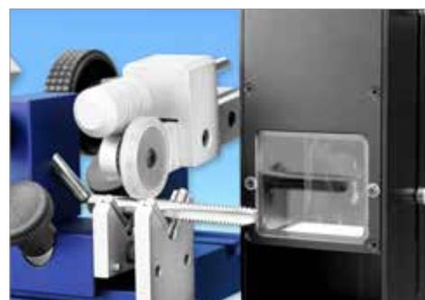
Le rétro-éclairage parallèle CV-LPW-B est livré dans un boîtier spécial fixé par une vis moletée à installer sur le chariot guidé. Le bloc d'alimentation spécial livré permet un réglage de la luminosité très précis.
