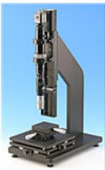
Pour une sûreté de processus élevée, nous vous recommandons d'utiliser des systèmes de zoom motorisés. Ceci vous évite ainsi d'oublier de modifier l'objectif dans le logiciel. La modification se fait automatiquement par le changement de système de mesure dans le logiciel de mesure. Le système de zoom est alors modifié via un moteur pas à pas.
