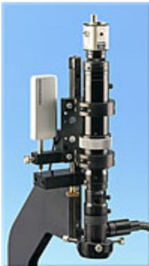
Un système de zoom à crans se compose de l'optique de zoom elle-même, 6,5x ou 12x, d'un adaptateur avec optique intermédiaire de 0,5x à 3,5x, de l'adaptateur C-Mount et de l'appareil photo. L'assemblage peut être fait selon vos exigences ou ensemble à l'usine au cours d'un test. La zone de zoom peut être modifiée par des bonnettes additionnelles. Les bonnettes déterminent la distance de travail.
