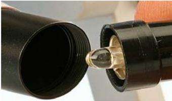
LED de remplacement pour l'éclairage coaxial 5 volts
