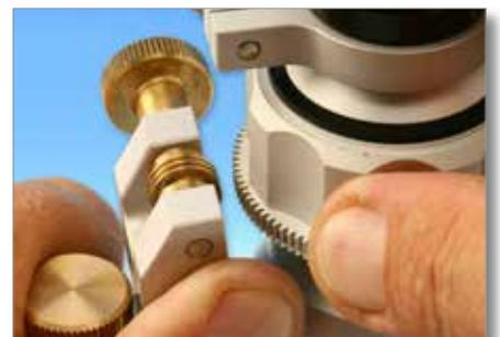
Pour utiliser le Cellcheck CIL-ZX comme système de laboratoire, vous pouvez lui ajouter un pied avec une table de mesure transversale 25 x 25 mm et une table rotative en option. Le pied est très pratique pour mesurer de petites pièces. Elles seront placées précisément sur la table transversale.
