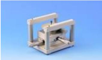
Support avec table de mesure transversale 25 x 25 mm, broches avec et table rotative pour les séries Cellcheck CIL et Cellcheck CIL-ZX
