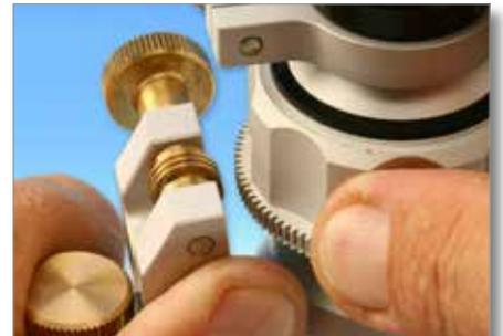
Poussez sur le côté le réglage de focale de précision pour effectuer un réglage rapide. Le pied MST permet d'avoir une position stable lors de la mesure de profondeur sur rouleaux ou matériaux plats. Une mise au point X supplémentaire de 5 mm assure, dans le cas de grossissements importants, l'avance entre les plans de focalisation lorsque ces derniers dépassent le champ de vision. Il est impossible d'utiliser une caméra USB avec un comparateur de mesure de profondeur.
