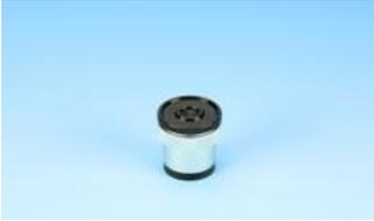
Oculaire pour les séries 2034 et 2054 (60 fois) avec une graduation de 0,02 mm
