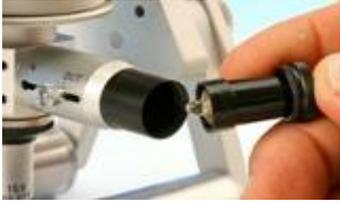
Module débrochable avec miroir semi-perméable pour un système d'éclairage coaxial pour les séries Cellcheck CIL et Cellcheck CIL-ZX
