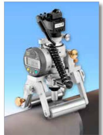
Le pied MST permet d'avoir une position stable lors de la mesure de profondeur sur rouleaux ou matériaux plats. Une mise au point X additionnelle de 5 mm assure, dans le cas de grossissements importants, l'avance entre les plans de focalisation lorsque ces derniers dépassent le champ de vision. Avec les logiciels Metric Standard ou Plus, vous pouvez afficher des images en 2D et mesurer entre autres,
