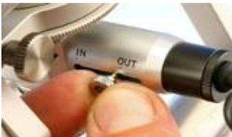
Vis spécial à ressort pour le module debrochable du système d'éclairage coaxial pour les séries Cellcheck CIL et Cellcheck CIL-ZX
