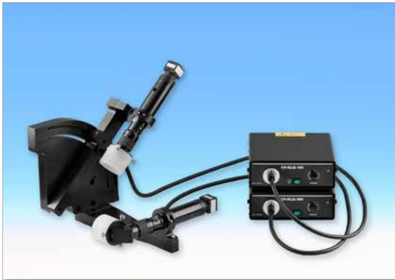
Le système peut aussi être livré sans pied. La livraison contient l'unité de réglage avec deux systèmes de zoom à crans, les lampes, des lumières d'anneaux d'écart avec diffuseur et sources de lumière froide, le logiciel Metric Plus (voir Metric - Liste des fonctions).
