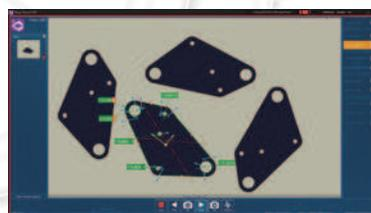
◀ Indicazioni dei risultati in formato grafico e numerico. Possibilità di misurazione simultanea di pezzi multipli.
